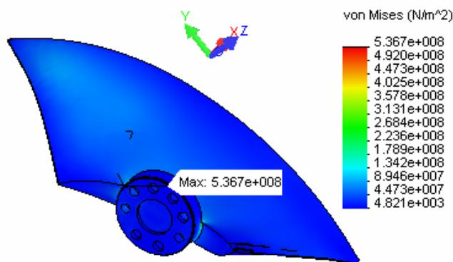
Fig. 9 – The von Mises plot.
